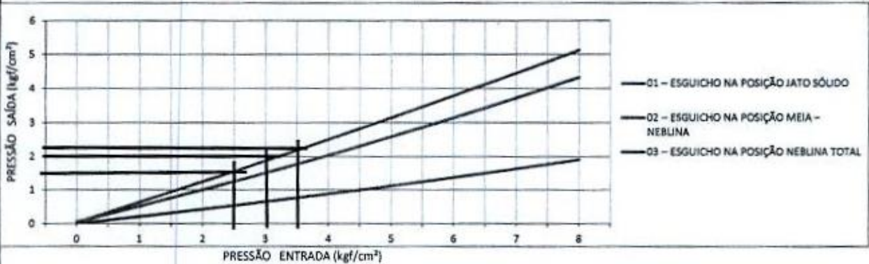
PRESSÃO ENTRADA x PRESSÃO SAÍDA
